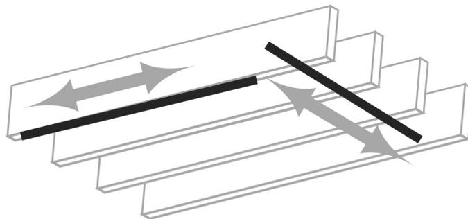
2. Befestigen Sie die Schiene (A) an der Decke und schrauben Sie die Holzschrauben (H) in die Balken / Träger.
