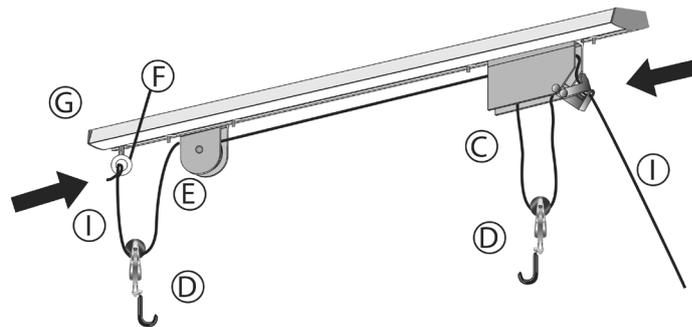
6. Messen Sie den Abstand zwischen Fahrradlenker und Sattel und verwenden Sie diesen, um den Hakenabstand an der Schiene zu ermitteln. Ziehen Sie mit dem mitgelieferten Inbusschlussel alle vier Anschlagblocke (E) fest, um die Riemenscheiben in dieser Position zu sichern. Verwenden Sie fur die Leiter die breiteste geeignete Breite.
