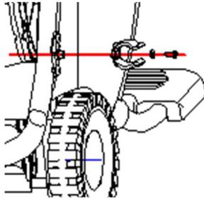
4. Installieren Sie mithilfe der Unterlegscheibe und des Splints das Rad an einer der Radachsen, biegen Sie ein Ende des Splints um und setzen Sie die Radabdeckung auf das Rad. Verfahren Sie mit dem anderen Rad auf die gleiche Art und Weise.
