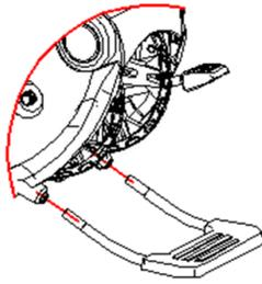
3. Befestigen Sie die Schlauchhalterung mit dem Schraubendreher an dem entsprechenden Plastikteil des Haltegriffs.
