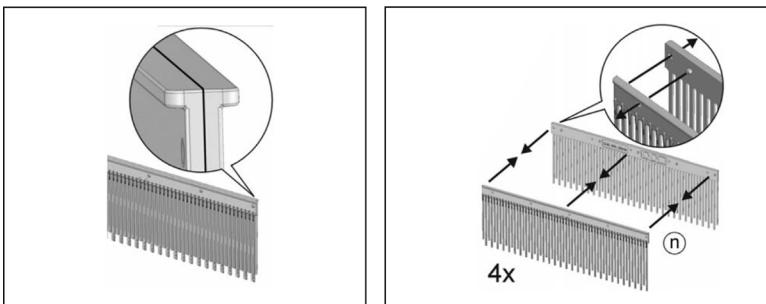
9. Halten Sie die montierten Bürsten-Sets zusammen und schieben Sie jeden Satz in die Rillen des Rotors, bis jedes Set eingerastet ist (Klick).
