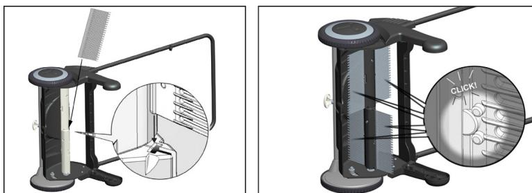
10. Schieben Sie den Auffangbehälter auf dem Griff in Position und schieben Sie die Verbindungen in die Vertiefungen auf dem Kehrmaschinen-Körper (m).
